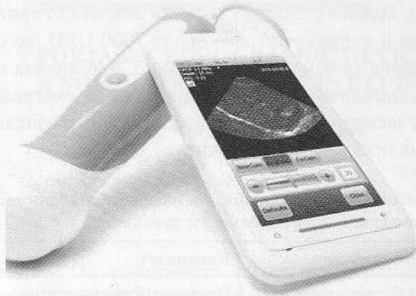
Фиг. 2. Ехографът MobiUs на фирмата Mobisante не само е с размерите на смартфон, а е базиран на реален смартфон (Toshiba TG 01, работещ под Windows Mobile 6,5). Сондата се свързва със смартфона към USB2 порта му
